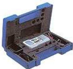
Kraftmesser im Etui, Standardzubehör, Netzgerät, Anschlußkabel FGC-CC, Werksbescheinigung 2.1 nach EN 10204, Bedienungsanleitung in deutsch und englisch
